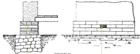
Схема 28. Устройство продуха
