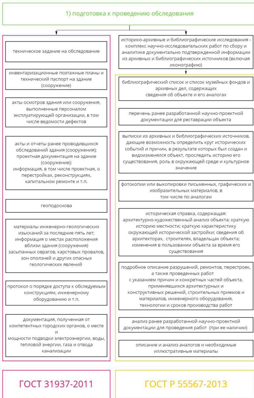
Рис. 31. Сравнительная блок-схема состава этапа «Подготовка к проведению обследования»
