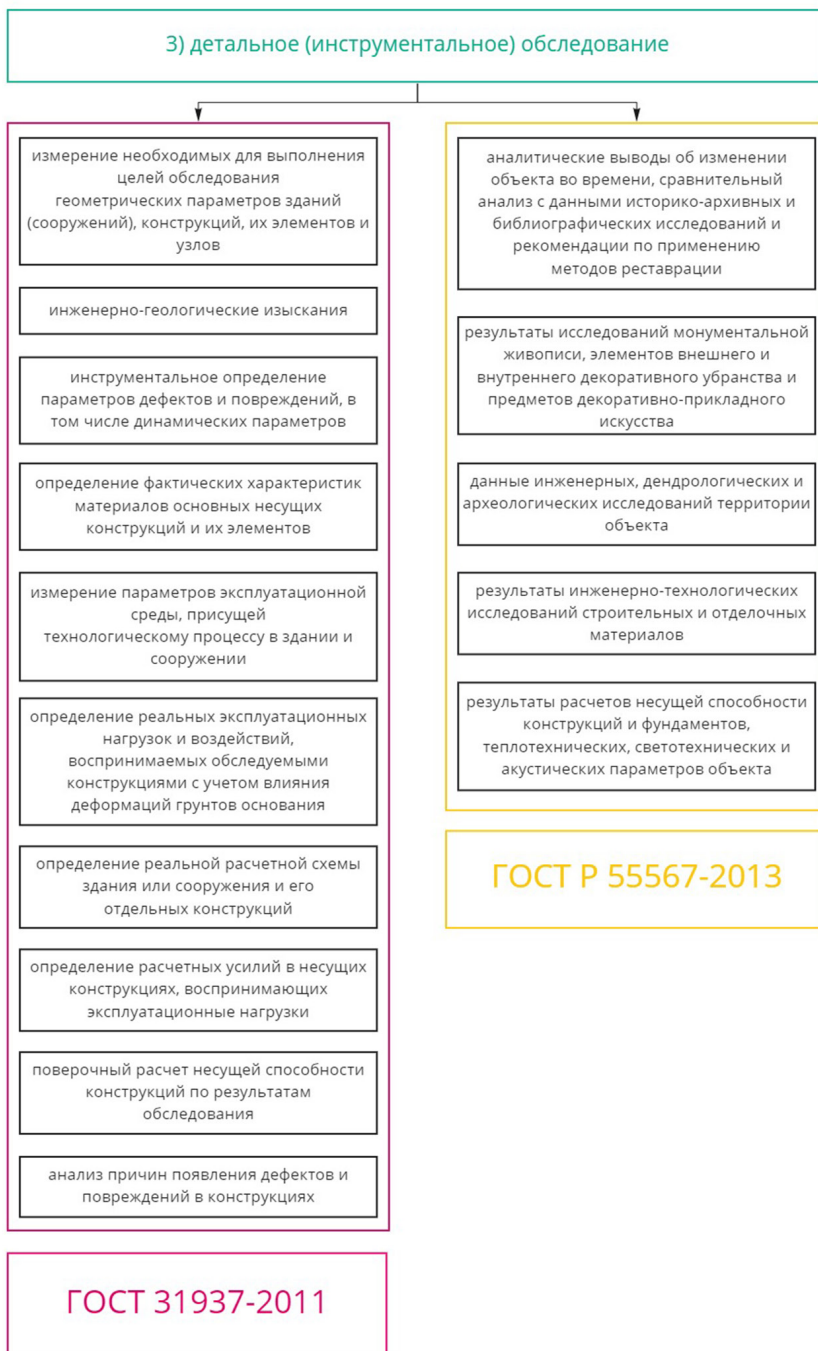
Рис. 33. Сравнительная блок-схема состава этапа «Детальное (инструментальное) обследование»
