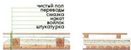
Схема 71. Устройство сплошного наката
