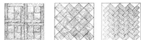
Схема 75. Рисунок раскладки паркета
