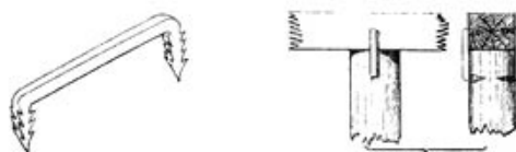
Схема 17. Соединения лежней со свайной скобой
