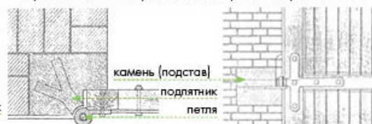
Схема 56. Устройство воротной петли
