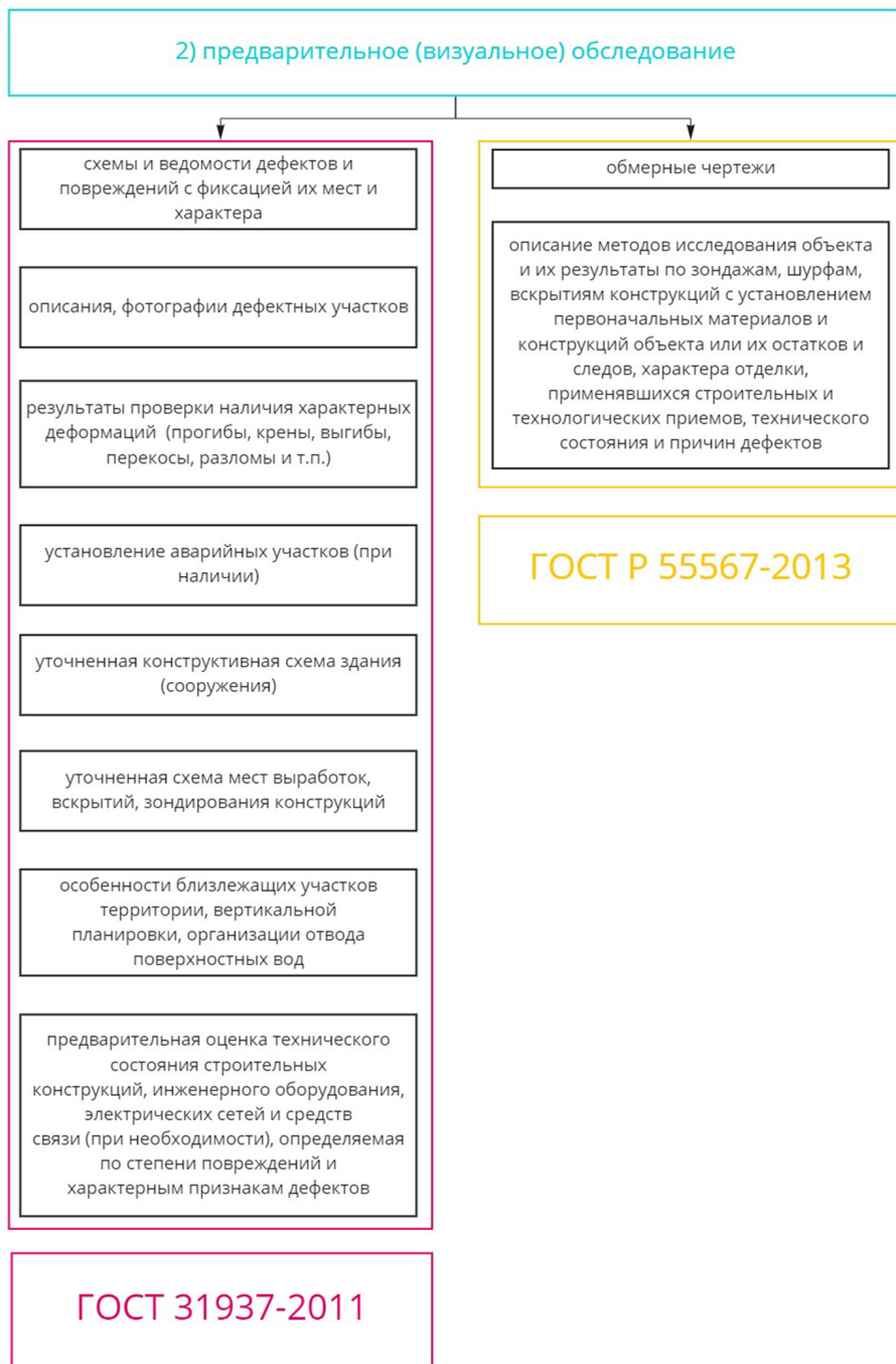
Рис. 32. Сравнительная блок-схема состава этапа «Предварительное (визуальное) обследование»
