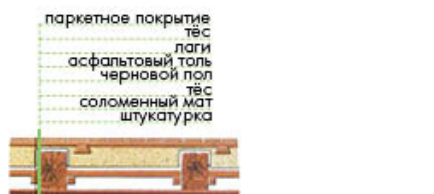
Схема 73. Перекрытие по деревянным балкам
