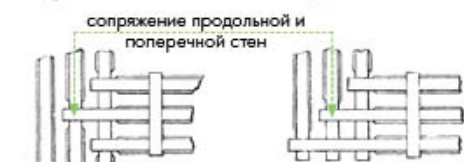
Схема 13. Раскладка лежней при пересечении стен или угловой конфигурации стены
