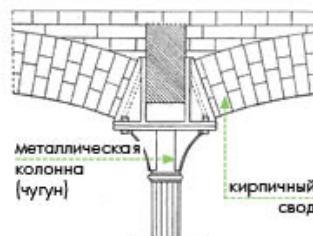
Схема 40. Способ перекрытия
