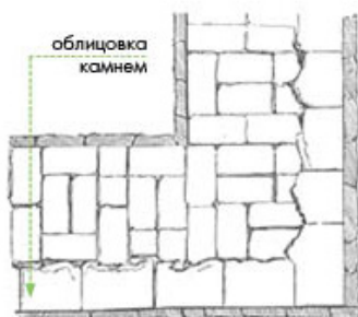
Схема 33. Угловая кладка
